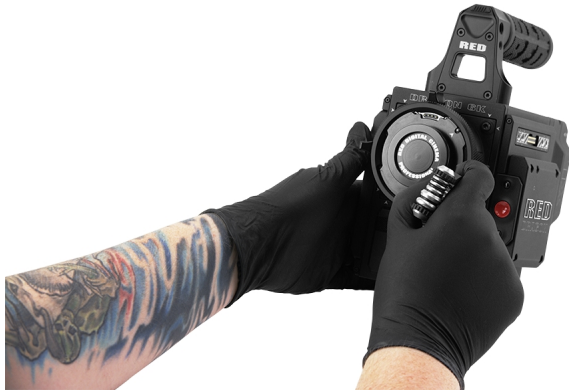
Figure: レンズマウントのねじを取り外します
