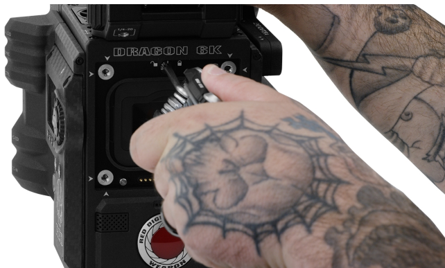
Figure: ロックを反時計回りに回します
