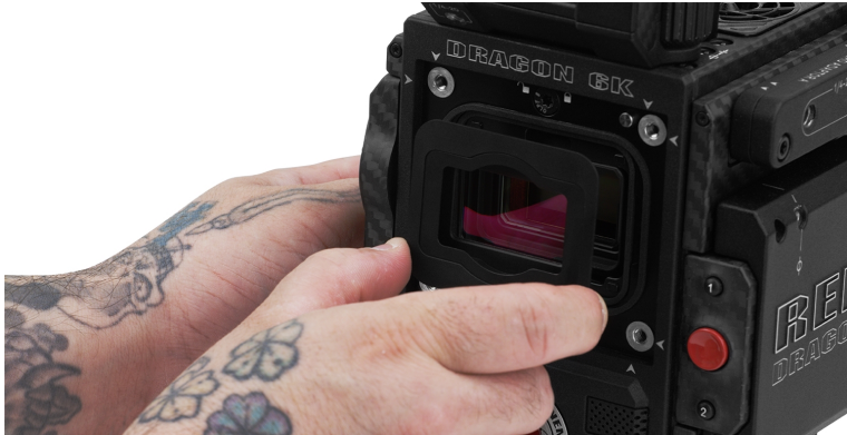
Figure: OLPF モジュールを取り外します
